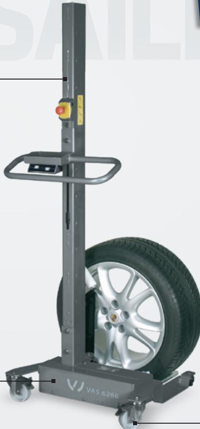
**Châssis de sécurité:** 4 roulettes orientables et un centre de gravité particulièrement faible permettent une manœuvrabilité excellente tout en gardant une stabilité élevée lors des basculements. Deux freins de blocage garantissent un état très sûr.
