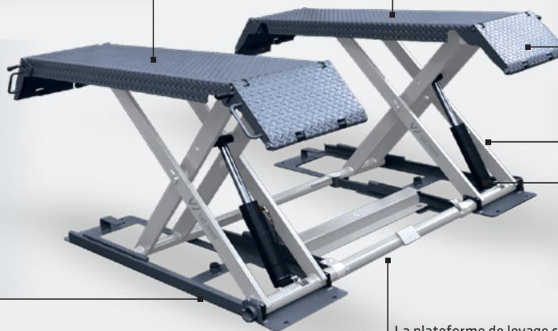
La plateforme de levage se caractérise par sa très grande facilité d'entretien : les axes d'articulation sont montés sur des paliers sans entretien et les conduites hydrauliques se trouvent bien à l'abri dans la traverse.
