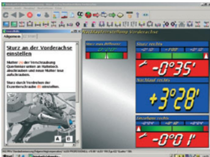
Klare Messwertanzeigen mit Soll-Istwertvergleich und eingblendete Hinweise machen die Vermessung und Einstellung einfach.
