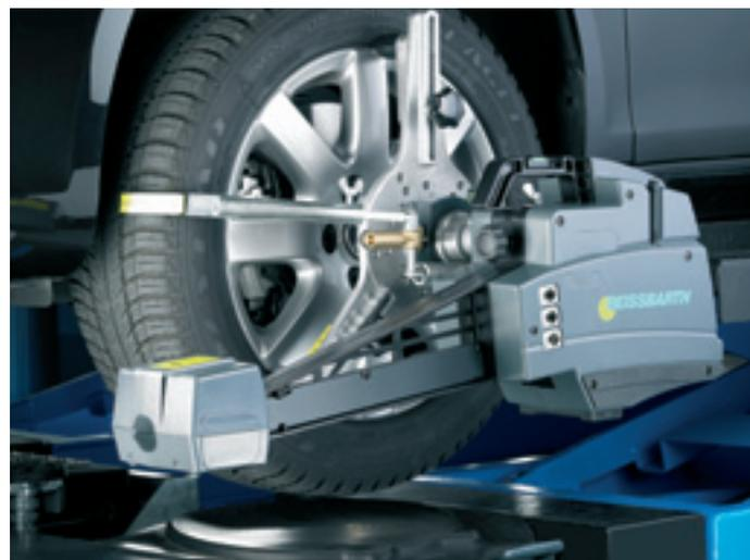
Praktisch: Die Akku-Messwertaufnehmer laden sich am Schrank über die Steckbolzen automatisch auf.
