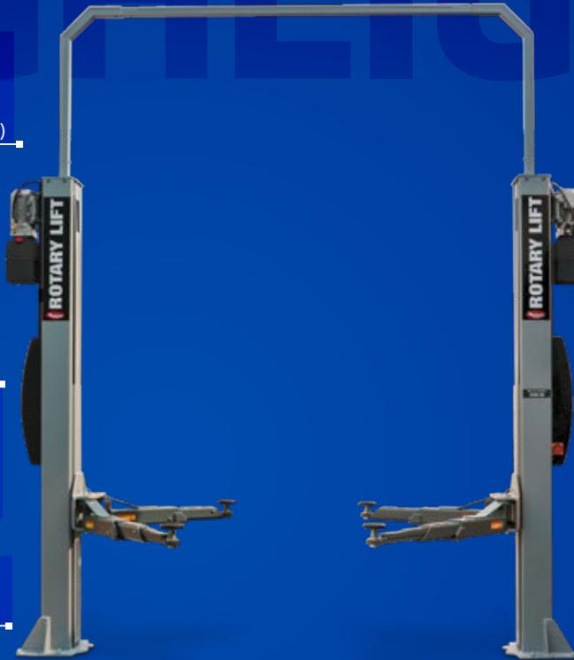
Zwei stehende Hydraulikzylinder übertragen über umgelenkte Lastketten die Kraft, somit fährt oder steht kein Zylinder über die Säule hinaus und ermöglicht so die minimale Bauhöhe von 2908 mm.
